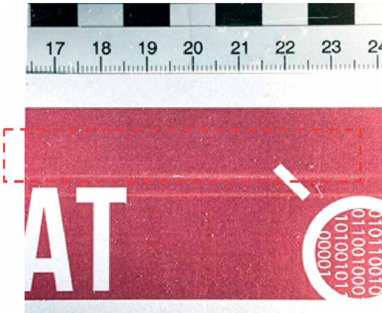
ryc. 10. Ślady na wydruku naniesione przez wadliwie działający odrywacz papieru. Źródło: autorzy.
