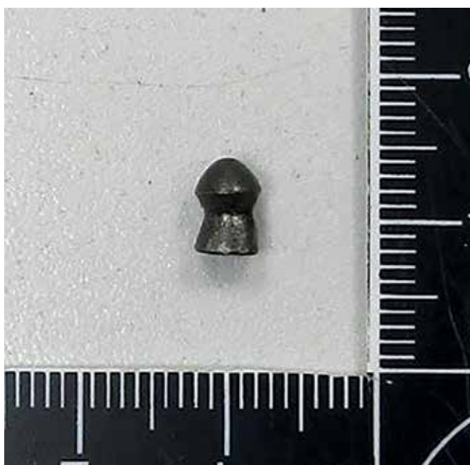
ryc. 4. Dowodowy pocisk kal. 4,5 mm „Diabolo Boxer” produkcji czeskiej przeznaczony do broni oraz urządzeń pneumatycznych wydobyty z rany postrzałowej klatki piersiowej pokrzywdzonego.
