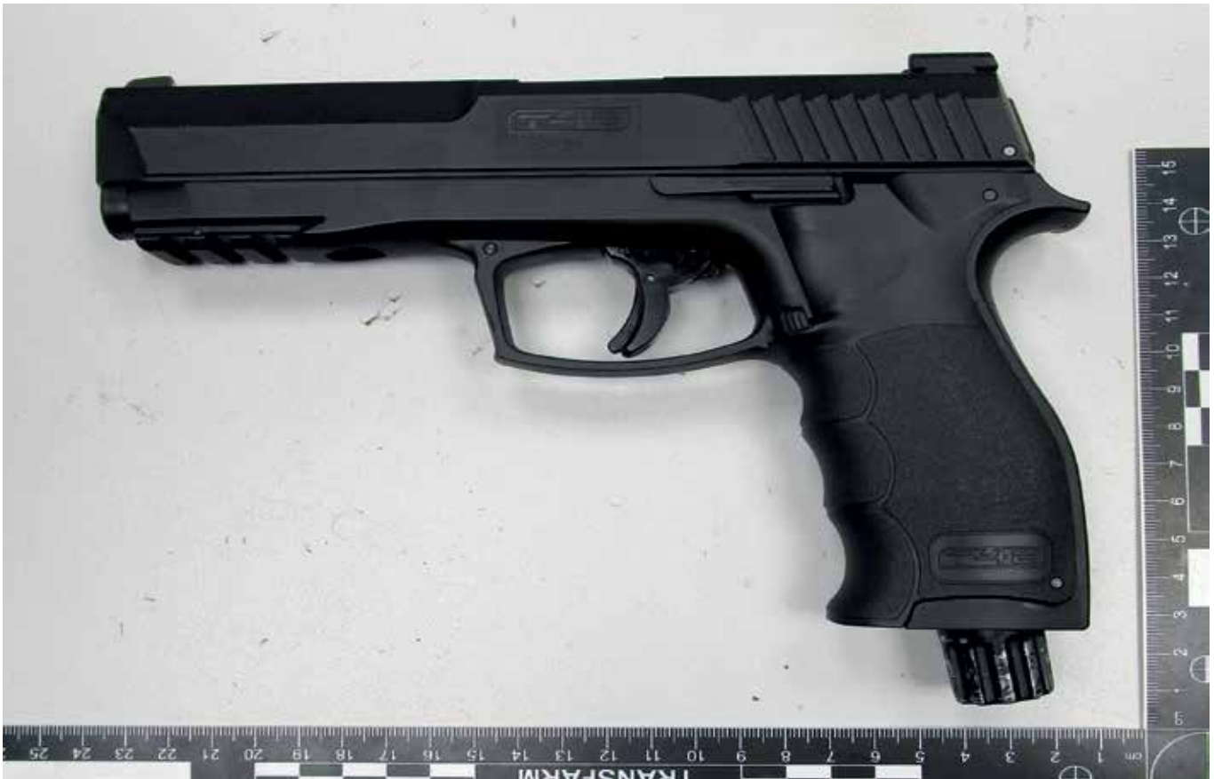
ryc. 5. Dostarczony do badań pistolet pneumatyczny Umarex Tw4E HDP 50 kal. 12,7 mm (50'') produkcji niemieckiej.
