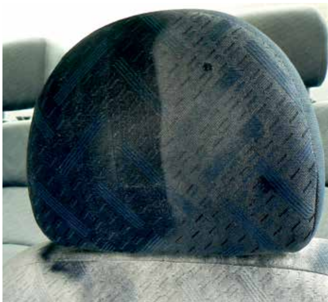
ryc. 15 Zagłówek po mechanicznym i ręcznym usunięciu proszku gaśniczego
