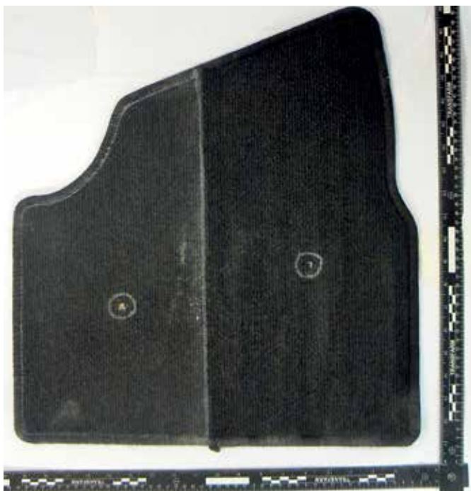
ryc. 7 Dywanik tekstylny po naniesieniu śladów i usunięciu mechanicznym i ręcznym proszku gaśniczego
