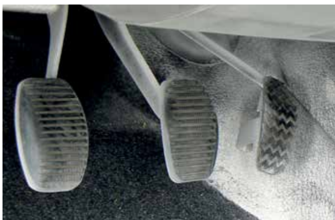
ryc. 17 Pedaly po usunięciu proszku gaśniczego
