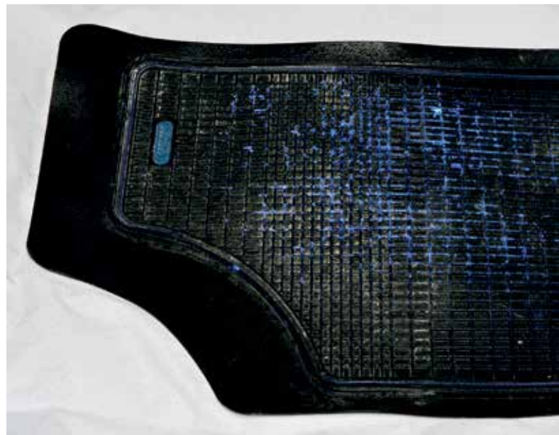
ryc. 14 Dywanik gumowy po usunięciu proszku gaśniczego i zastosowaniu luminolu
