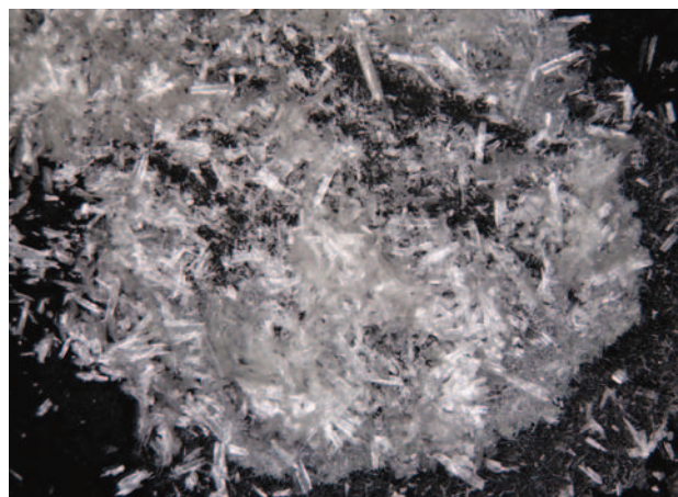
Ryc. 5. Oczyszczony materiał badawczy zastosowany do dalszych pomiarów instrumentalnych (zdjęcie wykonane za pomocą mikroskopu stereoskopowego MZAPO firmy Leica przy powiększeniu 8×).
