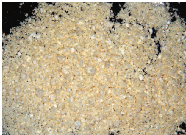
Ryc. 4. Nieoczyszczony, surowy materiał badawczy (zdjęcie wykonane za pomocą mikroskopu stereoskopowego MZAPO firmy Leica przy powiększeniu 8×).
