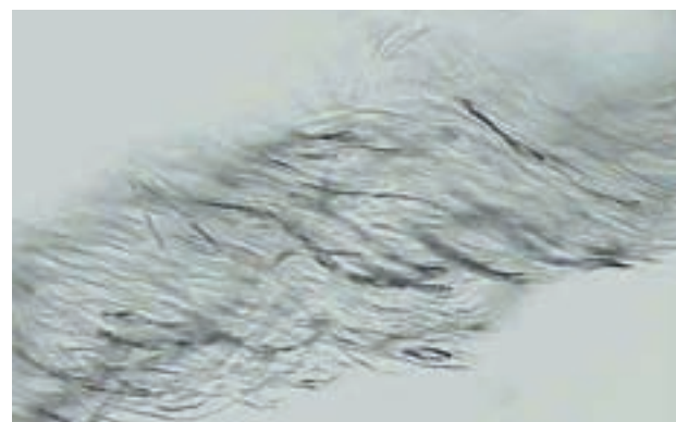
Ryc. 60, 61. Wygląd pojedynczych nitek bawełny prestige (97% bawełna, 3% elastan) pod mikroskopem badawczym w powiększeniu 100x. Od lewej tkanina fabrycznie nowa, tkanina po trzykrotnym praniu (materiały własne).
