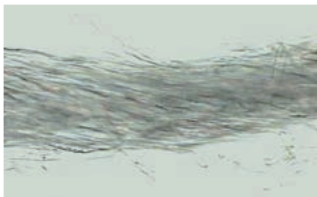
Ryc. 60, 61. Wygląd pojedynczych nitek bawełny prestige (97% bawełna, 3% elastan) pod mikroskopem badawczym w powiększeniu 100x. Od lewej tkanina fabrycznie nowa, tkanina po trzykrotnym praniu (materiały własne).
