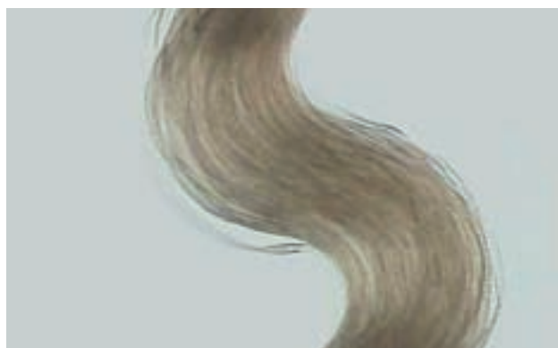
Ryc. 64, 65. Wygląd pojedynczych nitki poliestru (100% poliestru) pod mikroskopem badawczym w powiększeniu 100x. Od lewej tkanina fabrycznie nowa, tkanina po trzykrotnym praniu (materiały własne).
