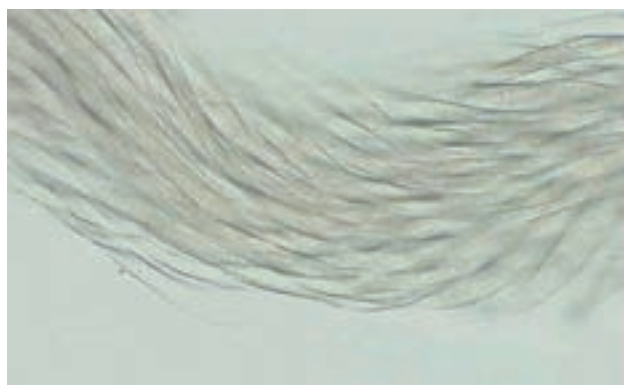
Ryc. 62, 63. Wygląd pojedynczych nitki wełny asti (60% wełna, 40% poliestru) pod mikroskopem badawczym w powiększeniu 100x. Od lewej tkanina fabrycznie nowa, tkanina po trzykrotnym praniu (materiały własne).
