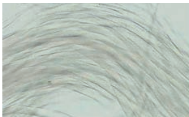
Ryc. 62, 63. Wygląd pojedynczych nitki wełny asti (60% wełna, 40% poliestru) pod mikroskopem badawczym w powiększeniu 100x. Od lewej tkanina fabrycznie nowa, tkanina po trzykrotnym praniu (materiały własne).
