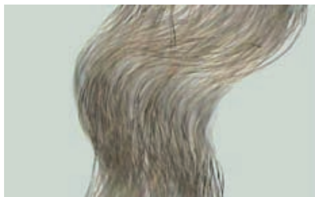
Ryc. 64, 65. Wygląd pojedynczych nitki poliestru (100% poliestru) pod mikroskopem badawczym w powiększeniu 100x. Od lewej tkanina fabrycznie nowa, tkanina po trzykrotnym praniu (materiały własne).
