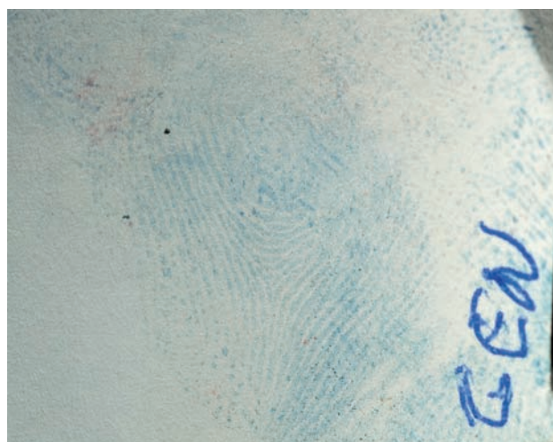
Ryc. 5. Ślad linii papilarnych ujawniony techniką sublimacji próżniowej genypiny – widok w świetle białym.
