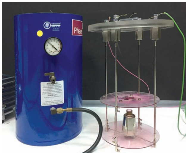
Ryc. 2. Wykorzystana w badaniach komora dedykowana do metody cyjanoakrylowej dostosowana do sublimacji innych substancji.
