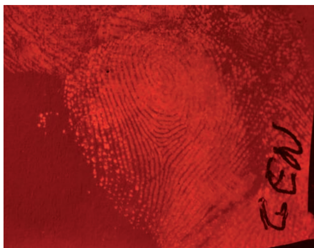
Ryc. 4. Ślad linii papilarnych ujawniony techniką sublimacji próżniowej genypiny – widok w trybie fluorescencji (wzbudzenie 575 nm, filtr krawędziowy długofalowy czerwony).
