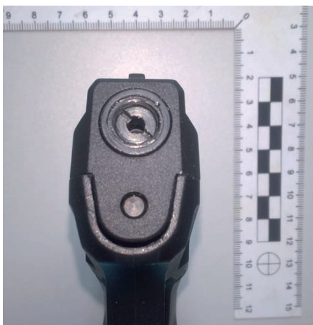
Ryc. 8. Korek z centralnym otworem zamontowany u wylotu lufy pistoletu ZORAKI mod. 906.
