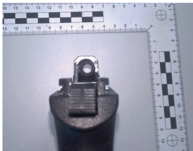
Ryc. 10. Widok przewodu lufy pistoletu ZORAKI po odłączeniu korka od wylotu lufy.
