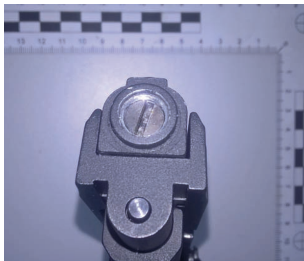
Ryc. 9. Korek (bez otworu) zamontowany u wylotu lufy pistoletu ZORAKI mod. 914-S.
