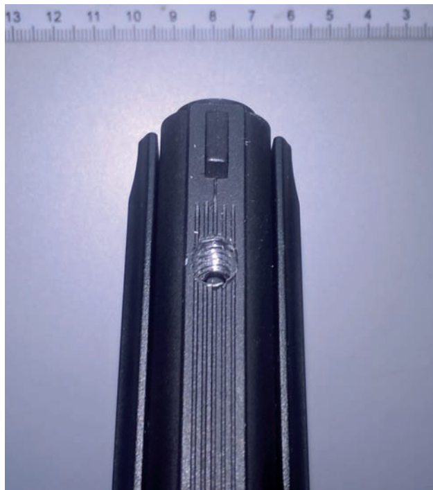
Ryc. 4. Gwintowany otwór w górnej ścianie lufy pistoletu ZORAKI mod. 914-S kal. 9 mm P.A.
