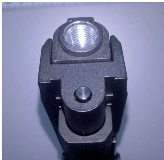
Ryc. 5. Gwintowany wylot lufy pistoletu ZORAKI mod. 914-S kal. 9 mm P.A.
