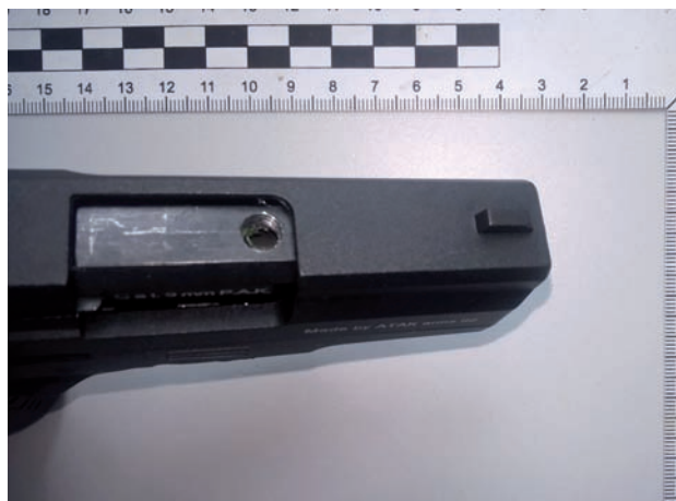
Ryc. 3. Gwintowany otwór w górnym płasku lufy pistoletu ZORAKI mod. 906 kal. 9 mm P.A.
