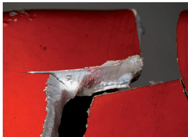
Ryc. 6. Materiał naniesiony na pęknięcie owiewki nr 1.
