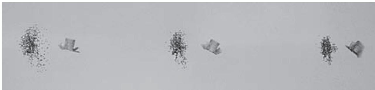
Ryc. 4. Widok śrucin na odcinku 1,4–2,1 m od wylotu lufy.
