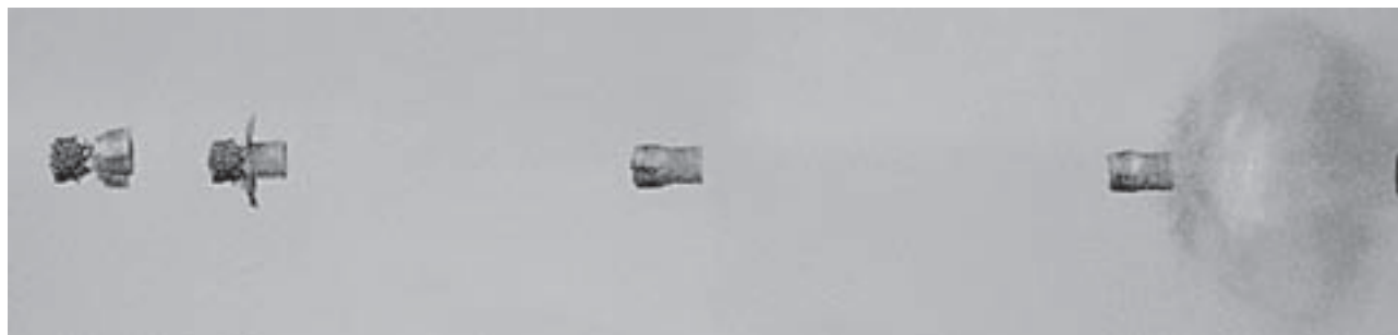
Ryc. 2. Widok śrucin na odcinku 0,0–0,7 m od wylotu lufy. Śruciny na wszystkich zdjęciach poruszają się od strony prawej do lewej.
