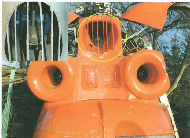
Ryc. 5. Miejsce lokalizacji zdemontowanego sygnalizatora oblodzenia na śmigłowcu Mi-2 oraz widok sygnalizatora z wyraźnym oznaczeniem jako źródła promieniowania radioaktywnego.
