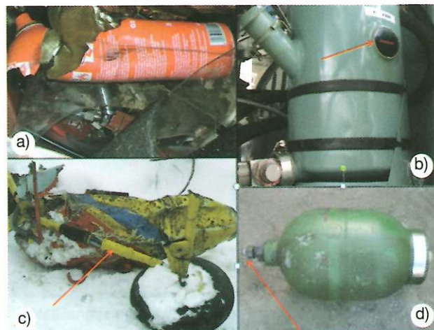
Ryc. 4. Różne zasobniki ciśnienia; a) pęknięta gaśnica pokładowa, b) zbiornik oleju – szkiełko pomiarowe wskazuje poziom oleju, c) amortyzator podwozia głównego śmigłowca, d) butla sprężonego gazu – króciec ładowania.
