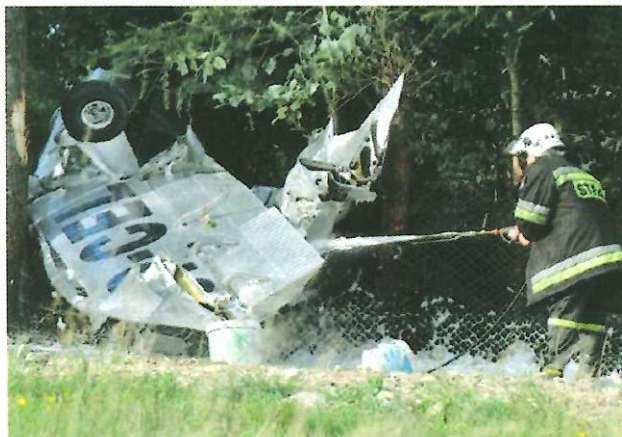
Ryc. 1. Zabezpieczenie miejsca wypadku przed pożarem poprzez podanie piany gaśniczej.
