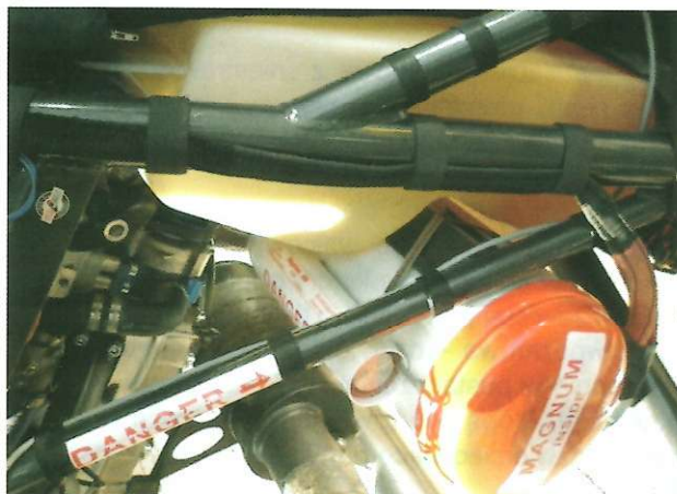
Ryc. 7. System ratowniczy zamontowany na wózku motoparalotni. Naklejki wyraźnie sygnalizują zagrożenie stwarzane przez spadochronowy system ratowniczy.
