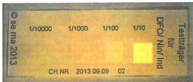
Ryc. 2. Aminokwasowy pasek testowy firmy SEMA GmbH po przereagowaniu z DFO – wzbudzenie 505 nm, OG590.
