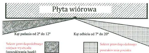
Ryc. 12. Kąt padania łuski i odbicia pocisku.
