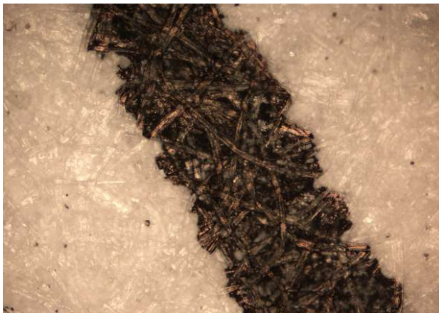
Ryc. 11. Wykonany piórem wiecznym zapis, który przeszedł przez drukarkę laserową (rozłożenie środka kryjącego wzdłuż włókien papieru, nieregularna linia brzegowa) – stukrotne powiększenie.
