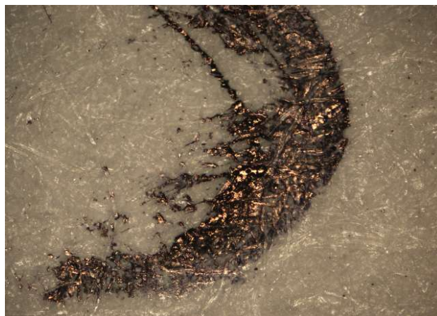
Ryc. 14. Wykonane długopisem zapisy, które przeszły przez drukarkę laserową (liczne rozpryski środka kryjącego poza linią zasadniczą pisma) – stukrotne powiększenie.
