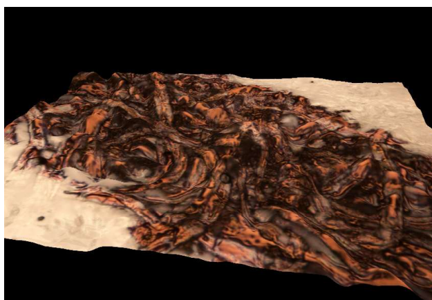
Ryc. 20. Wykonane długopisem zapisy, które przeszły przez drukarkę laserową – obraz 3D, dwustukrotne powiększenie.
