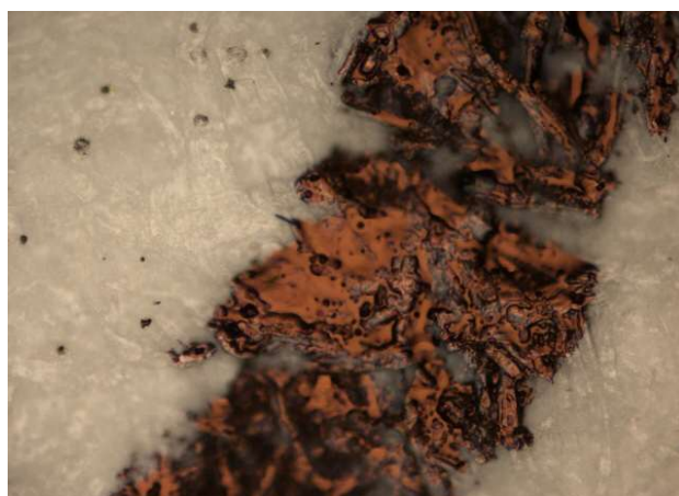
Ryc. 15. Wykonany długopisem zapis, który przeszedł przez drukarkę laserową (widoczne spieki) – stu- i dwustukrotne powiększenie.
