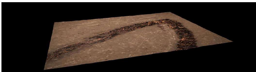
Ryc. 17. Wykonany długopisem zapis, który przeszedł przez drukarkę laserową (brak reliefu linii graficznej) – obraz 3D, pięćdziesięciokrotne powiększenie.
