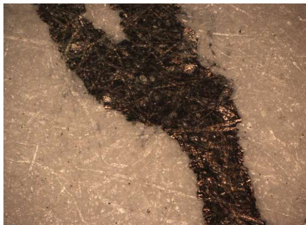
Ryc. 7. Wykonany piórem wiecznym zapis, który przeszedł przez drukarkę laserową (widoczne rozmazania środka kryjącego) – pięćdziesięciokrotne powiększenie.
