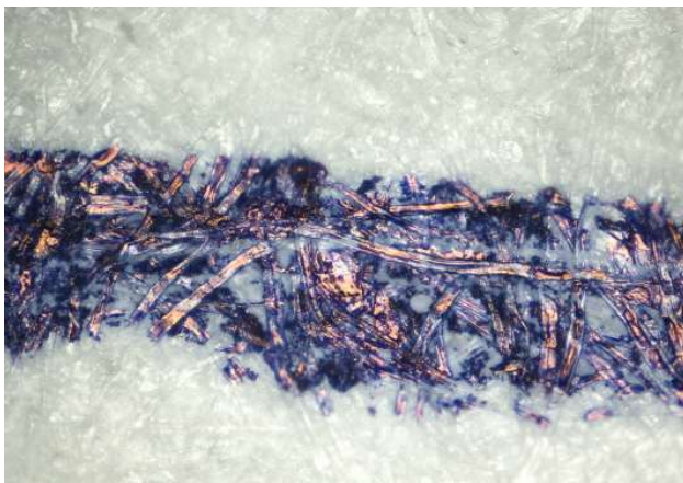
Ryc. 8. Wykonany długopisem zapis, który nie przeszedł przez drukarkę laserową (rozłożenie środka kryjącego wzdłuż kierunku kreślenia) – stukrotne powiększenie.
