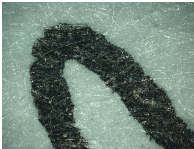
Ryc. 6. Wykonany piórem wiecznym zapis, który nie przeszedł przez drukarkę laserową – pięćdziesięciokrotne powiększenie.
