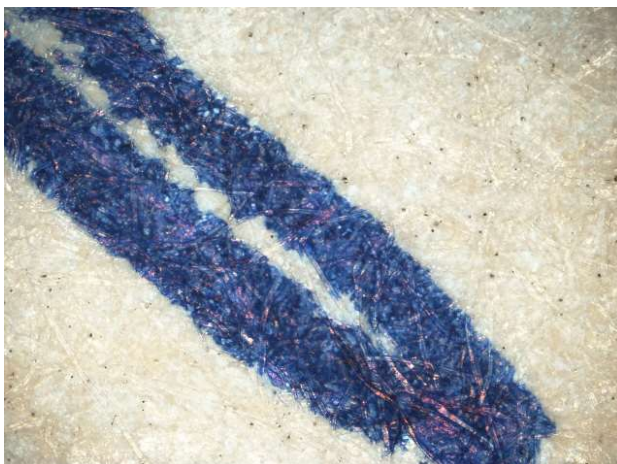
Ryc. 13. Wykonany długopisem żelowym zapis, który przeszedł przez drukarkę laserową (rozłożenie środka kryjącego wzdłuż włókien papieru, nieregularna linia brzegowa) – pięćdziesięciokrotne powiększenie.
