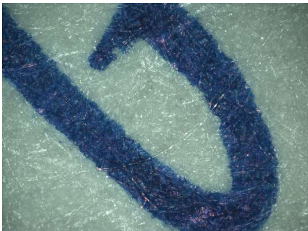
Ryc. 12. Wykonany długopisem żelowym zapis, który nie przeszedł przez drukarkę laserową (rozłożenie środka kryjącego wzdłuż kierunku kreślenia) – pięćdziesięciokrotne powiększenie.
