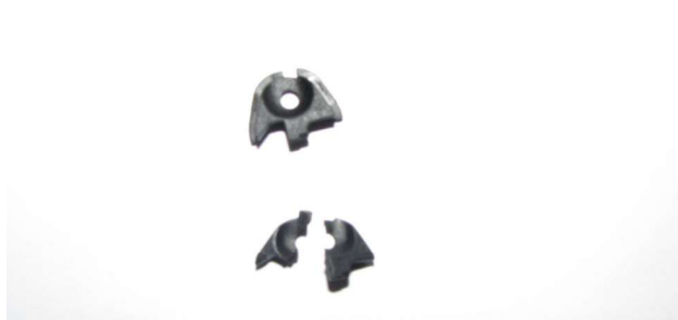
Ryc. 5. Zaślepka uszkodzona w trakcie zdarzenia oraz zaślepka nieuszkodzona.
