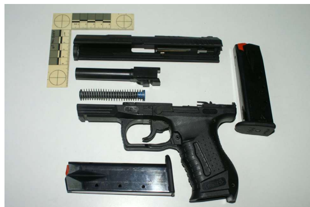
Ryc. 2. Pistolet WALTHER P99 kal. 9 mm w stanie częściowo rozłożonym.
