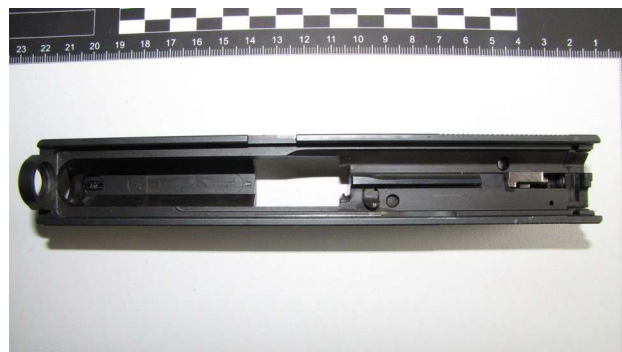
Ryc. 3. Widok dolnej części zamka pistoletu WALTHER P99 kal. 9 mm.
