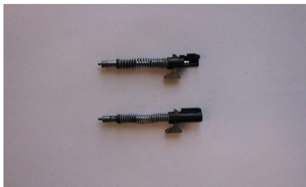
Ryc. 6. Uszkodzony bijnik zabezpieczony na miejscu zdarzenia oraz bijnik nieuszkodzony.
