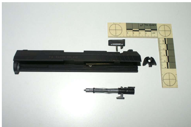
Ryc. 4. Zamek pistoletu WALTHER P99 z odłączonym mechanizmem iglicznym (bijnikiem), dźwignią zwalniania iglicy i zaślepką.
