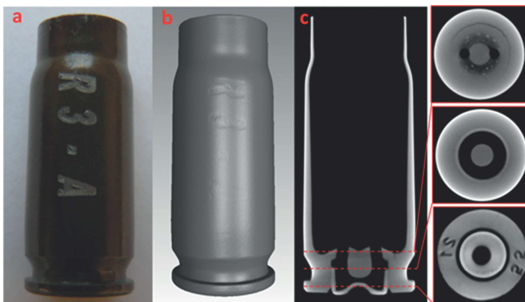
Ryc. 2. Wizualizacja łuski od naboju pistoletowego kal. 7,62 mm: obiekt rzeczywisty (a), trójwymiarowa rekonstrukcja iCT (b), przekroje 2D analizowanej łuski (c).
