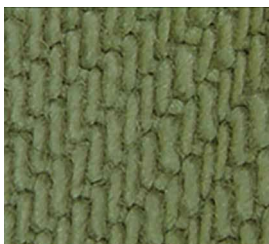
Ryc. 15. Bawełna, od lewej – niepoddana działaniu środka żrącego, poddana działaniu kwasu azotowego (obraz uzyskany za pomocą mikroskopu stereoskopowego).
