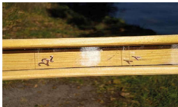
Ryc. 1. Ślady daktyloskopijne naniesione na płytki mikroskopowe, a następnie wsunięte do specjalnie wyżłobionej deski.
