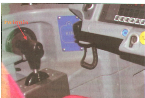
Ryc. 3. Umiejscowienie dźwigni nastawnika w kabinie motorniczego tramwaju 120 NaG Fig. 3. Location of lever adjuster in the 120 NaG tram driver cabin
