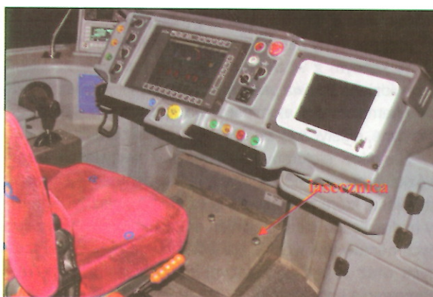
Ryc. 4. Umiejscowienie włącznika piasecznicy w kabinie motorniczego tramwaju 120 NaG Fig. 4. Location of riffle switch in 120 NaG tram driver cabin
