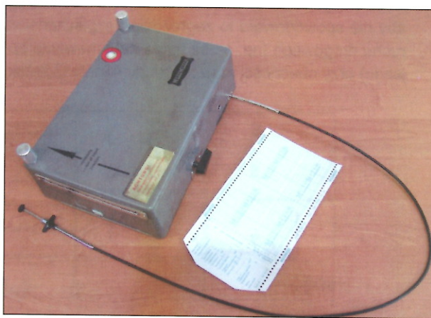
Ryc. 7. Opóźnieniomierz MOTOMETER, typ Prüf Nr 04 Fig. 7. Prüf Nr 04 type MOTOMETER decelerometer
