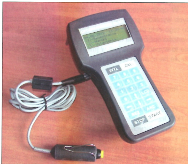
Ryc. 6. Opóźnieniomierz ZEPWN typu CL 170 Fig. 6. CL 170 type ZEPWN decelerometer
