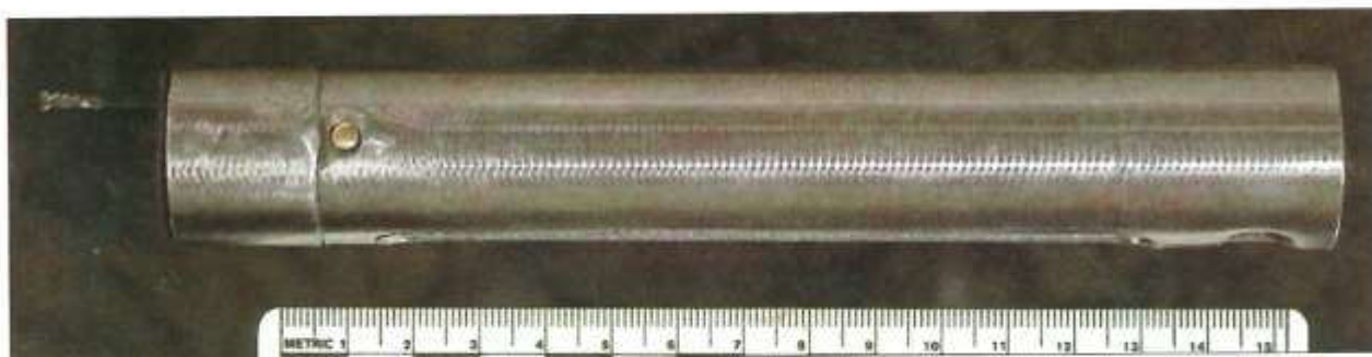
Ryc. 5. Widok boczny bijnika przerobionego karabinka pneumatycznego. Fig. 5 Side view of striker originating from converted air gun
