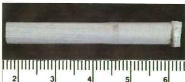
Ryc. 9. Widok boczny repliki silikonowej fragmentu przewodu lufy karabinka sportowego CZ mod. 2 kal. 5,6 mm (.22) long rifle z odwzorowaną komorą nabojową Fig. 9. Side view of silicon replica of barrel fragment originating from CZ model 2, cal. 22 long rifle with impressed cartridge chamber
