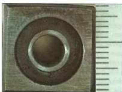
Ryc. 3. Widok wlotu lufy przerobionego samodzielnego karabinka pneumatycznego od strony komory nabojeowej
