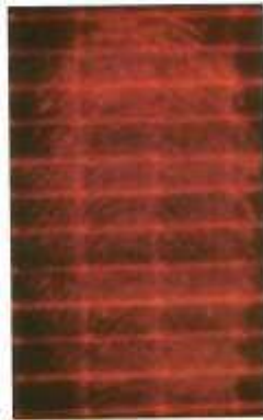
Ryc. 22. Świeży ślad linii papilarnych skonstrastowany safraniną O po pierwszym przyłożeniu na klejącej stronie taśmy montażowej
