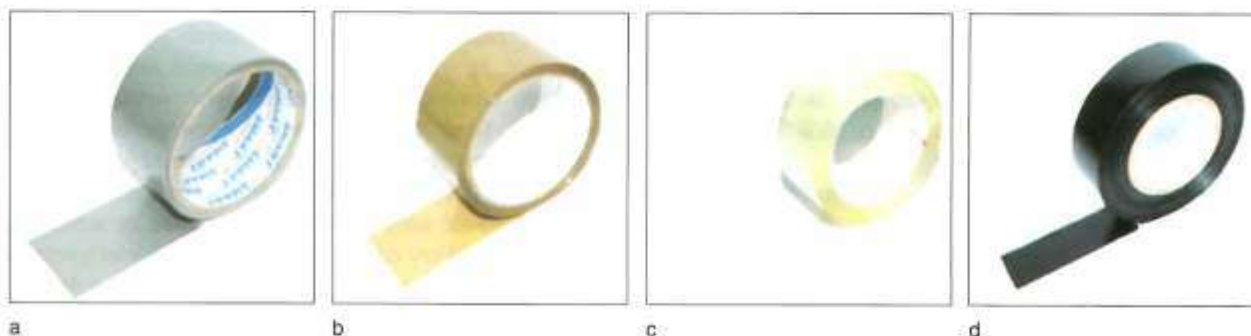
Ryc. 1. Taśmy wykorzystane w badaniach: a) montażowa koloru srebrnego, b) beżowa pakowa, c) przezroczysta biurowa, d) czarna izolacyjna Fig. 1. Tapes used in examinations: a) silver duct tape b) beige filament tape c) transparent office tape d) black insulating tape.
