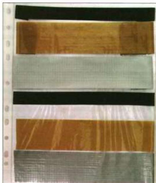
Ryc. 2. Podłoża użyte do badań (od dołu strona nieklejąca taśm: montażowej, beżowej, izolacyjnej, biurowej i strona klejąca taśm: montażowej, beżowej, izolacyjnej, biurowej)
