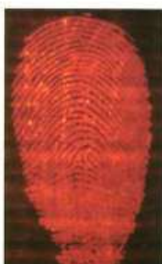
Ryc. 19. Miesięczny ślad linii papilarnych po pierwszym przyłożeniu skonstrastowany safraniną O na nieklejącej stronie taśmy montażowej
