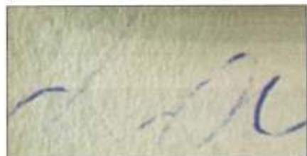
Ryc. 7. Zapis wykonany długopisem Frixion Ball z lekkim naciskiem na podłoże (oznaczony w celach badawczych jako 2.e.) i jego powiększony fragment Fig. 7. Entry made with Pilot Frixion Ball with light writing pressure applied (designated as 2.e. for examination purposes) and the enlargement of its fragment
