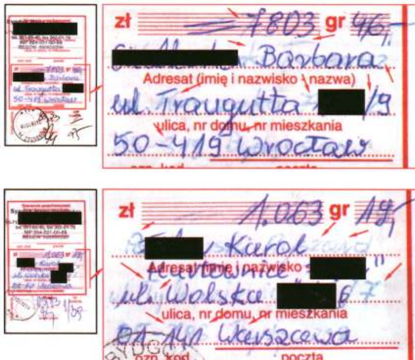
Ryc. 2. Przykładowe dowodowe przekazy oraz powiększenie ujawnionych w wyniku schłodzenia widniejących na nich zapisów pierwotnych w obrębie zapisów sporządzonych wtórnie
