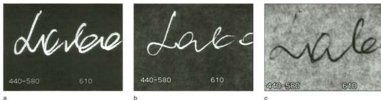
Ryc. 11. Zdjęcia fragmentów zapisów wykonanych: a – długopisem Pilot Frixion Ball, b – długopisem Pilot Frixion Point, c – długopisem Replay Paper Mate (obraz z VSC4C)
