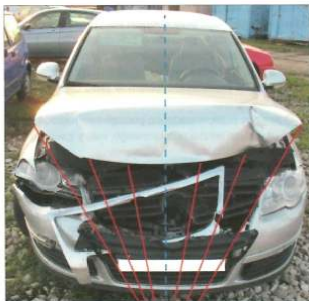
Ryc. 32. Graficzne przedstawienie pomiaru położenia cofniętej przedniej krawędzi pokrywy komory silnikowej
