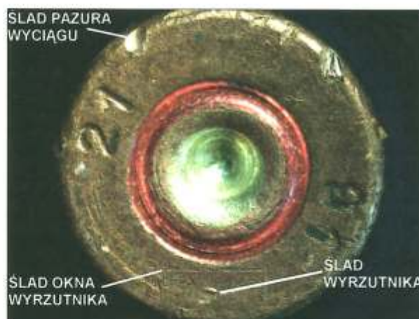
Ryc. 10. Widok dna łuski pochodzącej od naboju pistoletowego kal. 9 mm wz. Makarov odstrzelonego w trakcie badań z pistoletu maszynowego BERETTA wz. 1938/42
