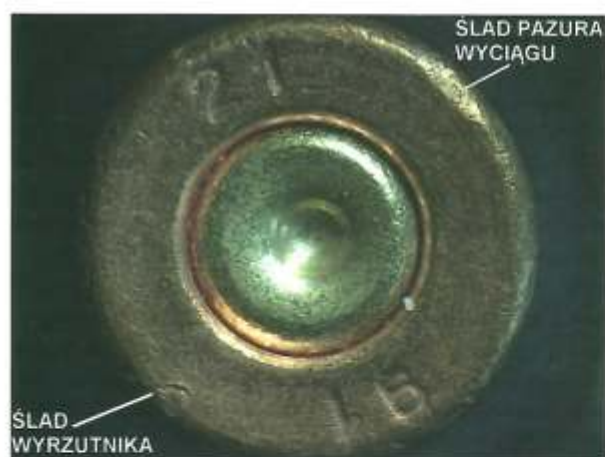
Ryc. 9. Widok dna łuski pochodzącej od naboju pistoletowego kal. 9 mm wz. Makarov odstrzelonego z pistoletu maszynowego PM-63 (RAK)
