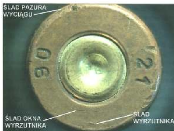
Ryc. 8. Widok dna łuski pochodzącej od naboju pistoletowego kal. 9 mm wz. Makarov zabezpieczonej na miejscu przestępstwa
