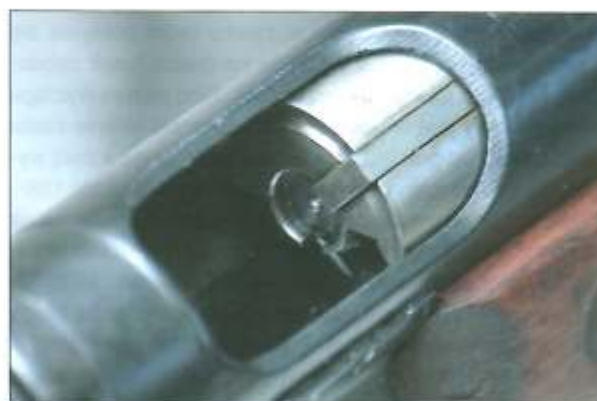
Ryc. 6. Widok czołka zamka oraz wyrzutnika w pistolecie maszynowym BERETTA wz. 1938/42 (przez okienko wyrzutowe)
