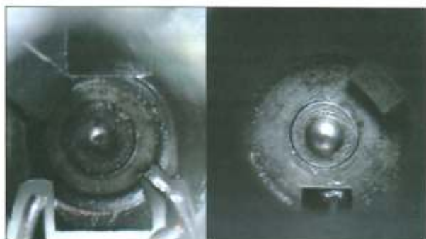
Ryc. 7. Wzajemne usytuowanie pazura wyciągu i wyrzutnika w pistolecie maszynowym PM-63 (RAK) (a) oraz w pistolecie maszynowym BERETTA wz. 1938/42 (b) widoczne przez przewód lufy egzemplarzy broni
