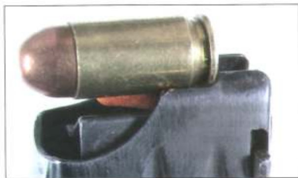
Ryc. 3. Początek współpracy naboju wyrzucanego z pistoletu maszynowego PM-63 z powierzchnią czołową wyrzutnika (lewa szczeka magazynka nabojeowego)
