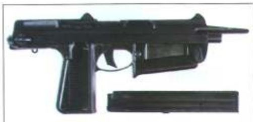
Ryc. 1. Widok prawej strony pistoletu maszynowego PM-63 (RAK) kal. 9 mm z odłączonym magazynkiem nabojeowym
