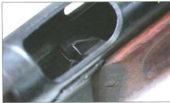
Ryc. 4. Widok wyrzutnika w pistolecie maszynowym BERETTA wz. 1938/42 (od strony okienka wyrzutowego)
