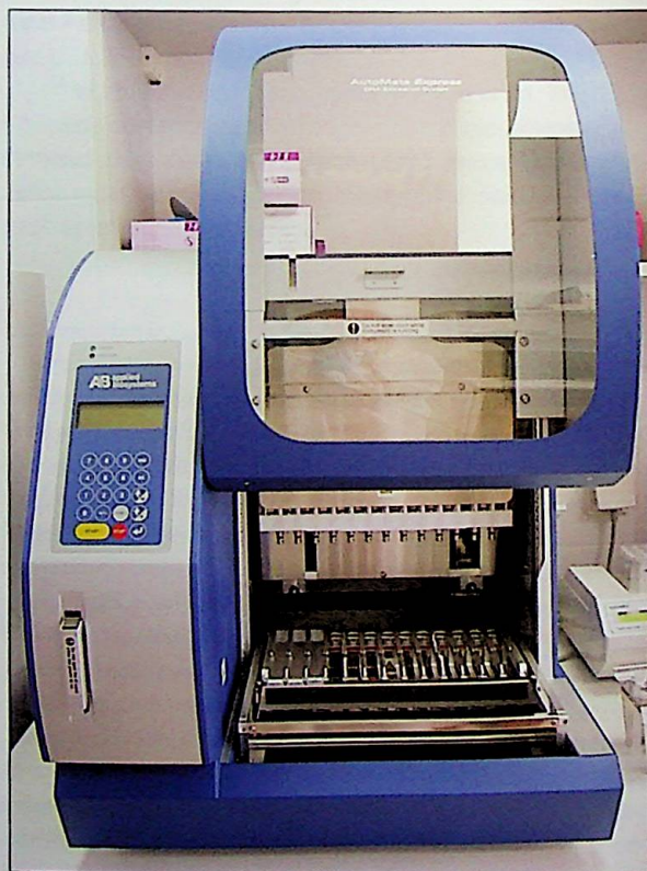
Ryc. 1. Stacja robocza do automatycznej izolacji DNA z zastosowaniem kulek magnetycznych – AutoMate Express™ Instrument
