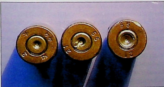
Ryc. 1. Dna łusek odstrzelonych naboju do pistoletów – (od lewej) TT wyprodukowany 1953 roku, TT wyprodukowany w 1950 roku, maszynowy Sudajewa wz. 43
