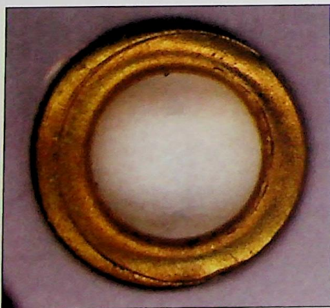
Ryc. 9. Niefachowe zaciskanie nitów pozostawiało na nich widoczne ślady Fig. 9. Non-professional fixing of rivets left visible marks
