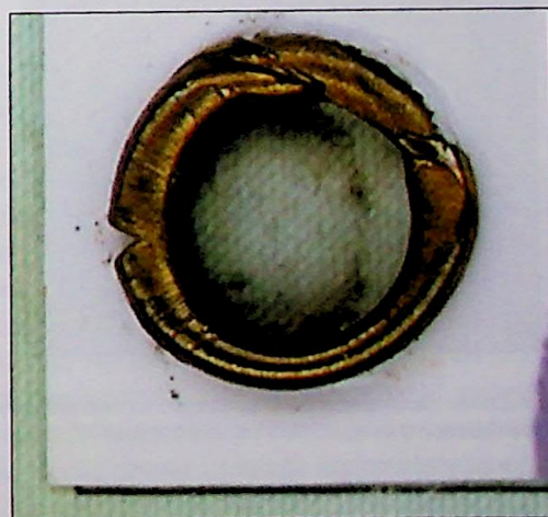
Ryc. 8. Uszkodzenia nitu mocującego fotografię
