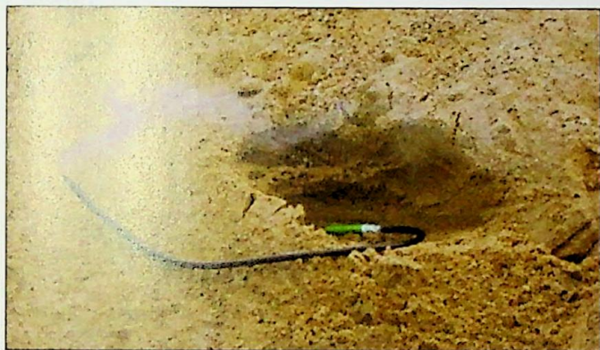
Ryc. 7. Odpalenie jednego z zapalników w obudowie z tworzywa sztucznego Fig. 7. Blasting of one of fuses in plastic casing
