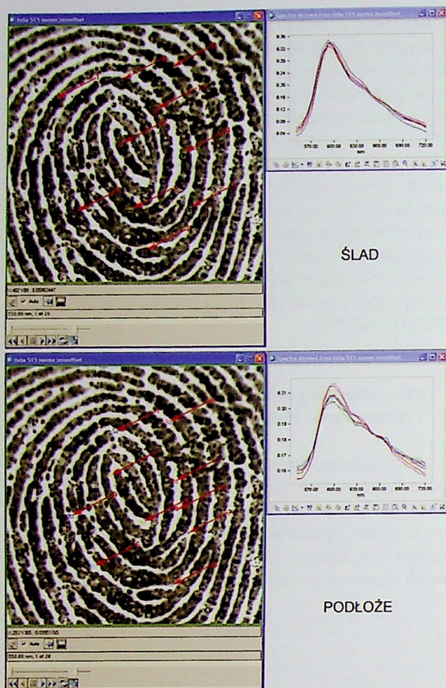
Ryc. 6. Sposób wyznaczania 10 punktów pomiarowych na powierzchni ujawnionego śladu oraz podłoża
