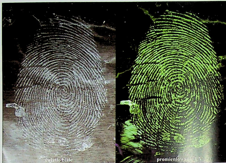
Ryc. 2. Ślad linii papilarnych na folii aluminiowej ujawniony metodą cyjanoakrylową i skonstrastowany barwnikiem fluorescencyjnym Ardrox w świetle białym oraz promieniowaniu UV
