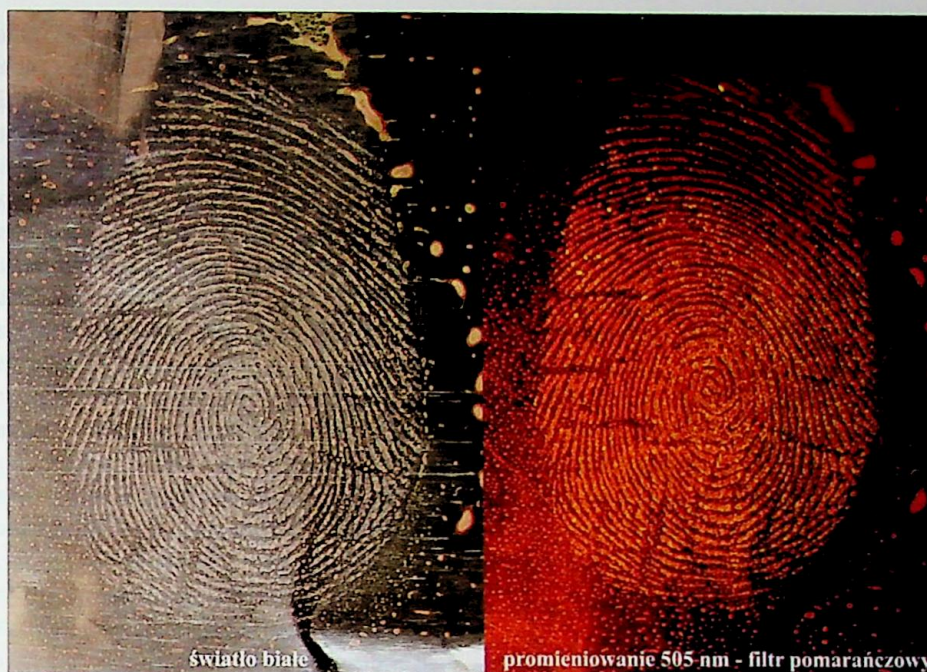
Ryc. 3. Ślad linii papilarnych na folii aluminiowej ujawniony metodą cyanoakrylową i skontrastowany barwnikiem fluorescencyjnym Safranina O, w świetle białym oraz promieniowaniu o długości fali 505 nm z filtrem pomarańczowym
