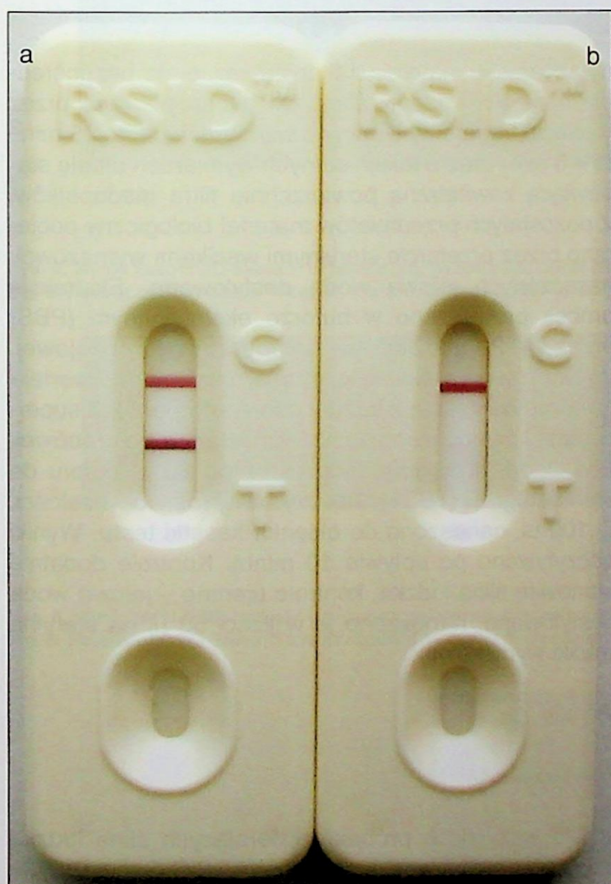
Ryc. 2. Pozytywny wynik (a) i wynik negatywny (b) testu RSID-Saliva™, C – linia kontrolna, T – linia testowa
