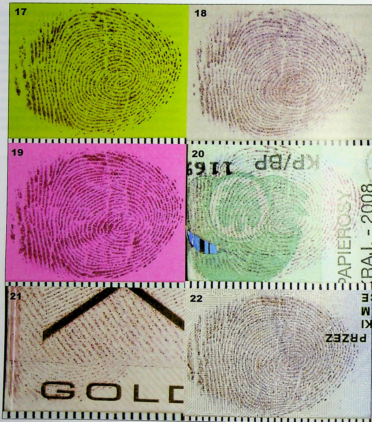
Ryc. 5. Wykorzystane w badaniach ślady linii papilarnych ujawnione metodą ninhydrynową na podłożach oznaczonych nr 17–22 Fig. 5. Latent fingerprints developed by ninhydrin method on substrates number 17 – 22 and used in the research
