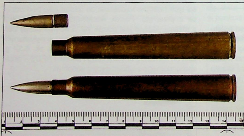
Ryc. 7. Nabój kal. 7,92 mm x 107 Fig. 7. Cal 7,92 mm x 107 cartridge
