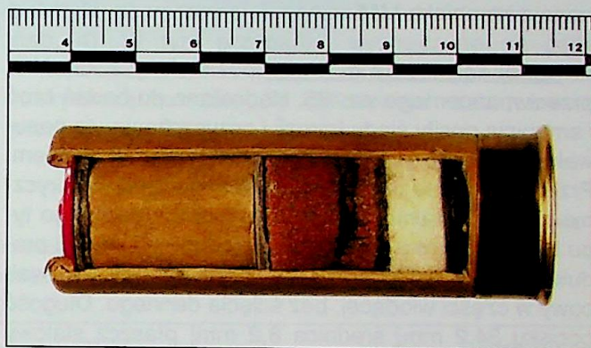
Ryc. 5. Nabój sygnałowy kal. 26 mm produkcji polskiej Fig. 5. Cal. 26 mm signal cartridge of Polish production
