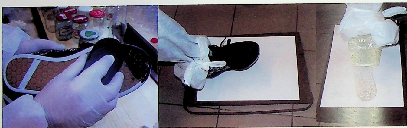
Ryc. 12. Wykonanie śladów próbnych: a) nasmarowanie powierzchni podeszwy buta, b–c) wykonanie śladu na kartce papieru poprzez przyłożenie podeszwy buta do kartki papieru
