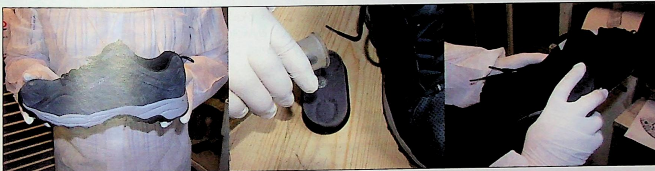
Ryc. 5. Kolejność czynności w czasie ujawniania śladów metodą z wykorzystaniem oliwki i proszku ferromagnetycznego: a) but porównawczy, b) nasączenie gąbki kilkoma kropelkami oliwki dla niemowląt, c) równomierne naniesienie (natłuszczenie) na powierzchnię podeszwy oliwki Fig. 5. Subsequent stages of developing marks with use of baby olive and ferromagnetic powder: a) comparative print, b) pouring a few drops of baby olive onto a sponge, c) even spreading of olive on shoe sole
