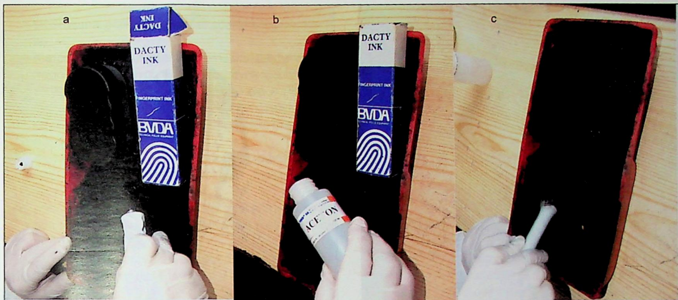
Ryc. 1. Kolejne etapy przygotowania nośnika śladu: a) wyciśnięcie tuszu daktyloskopijnego do naczynia, b) dodanie acetonu, c) wymieszanie składników do konsystencji gęstego płynu w naczyniu
