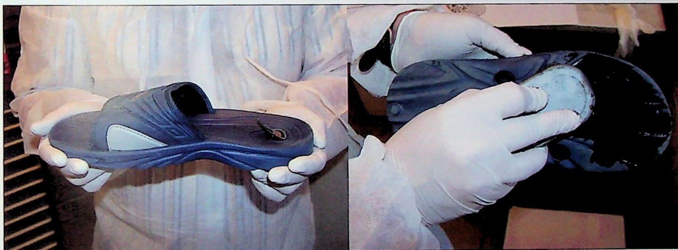
Ryc. 2. Pokrycie powierzchni buta uzyskaną mieszaniną tuszu daktyloskopijnego z acetonem
