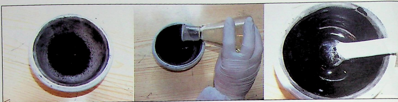
Ryc. 11. Etapy przygotowania nośnika śladu: a) wsypanie do moździerza odrobiny sadzy (1 łyżka stołowa), b) dodanie do moździerza oliwki dla niemowląt (1 łyżka stołowa), c) wymieszanie do płynnej konsystencji składniki (bez grubych ziaren sadzy)
