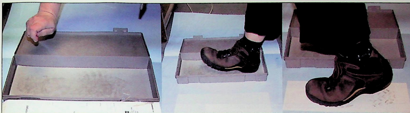
Ryc. 9. Wykonywanie śladów powierzchniowych z wykorzystaniem urządzenia Print Kit: a) nasączenie podłoża roboczego tuszem, b) nasączenie powierzchni podeszwy w podłożu roboczym, c) wykonanie śladu na karcie śladu
