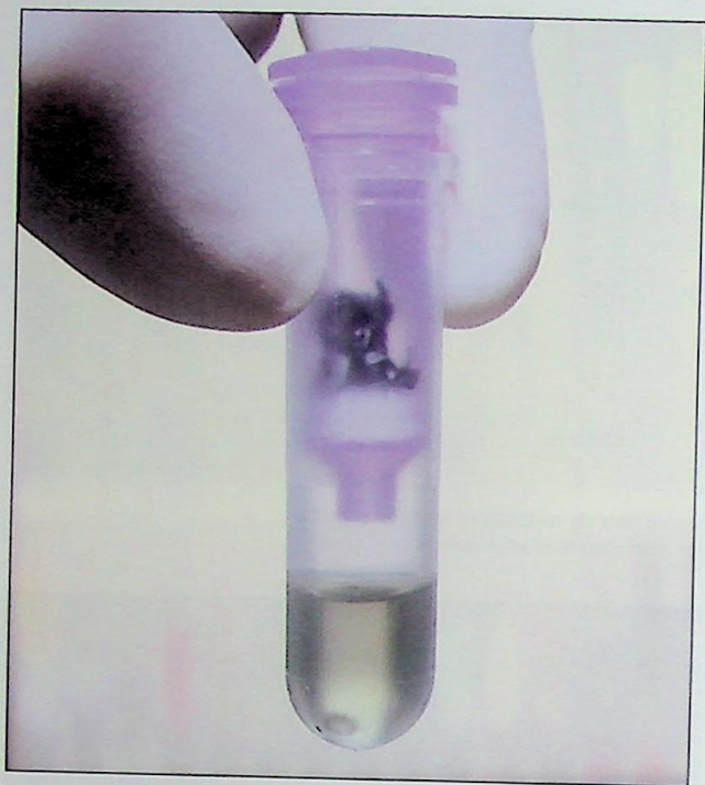
Ryc. 6. Podłoże na filtrze QIAshredder po zwirowaniu (QIAamp® DNA Micro)
