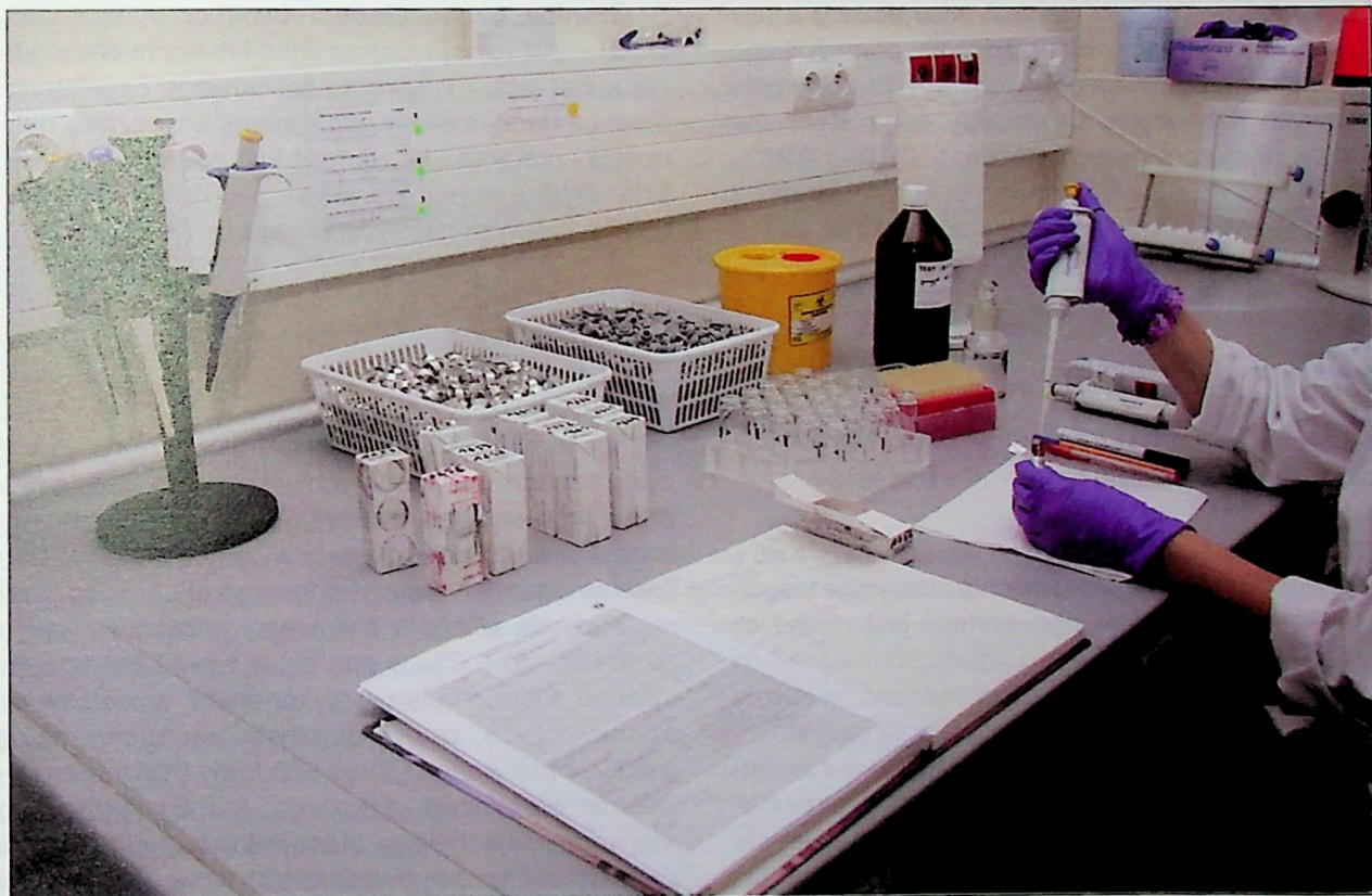
Ryc. 3. Wyposażenie stanowiska przeznaczonego do przygotowania próbek do analizy metodą chromatografii head-space Fig. 3. Workstation for preparation of samples to head-space chromatography analysis
