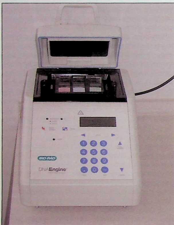
Ryc. 2. Termocykler z przystawką do hybrydyzacji in situ Fig. 2. Thermocycler equipped in with in situ hybridization heater źródło (ryc. 2–3): autorzy
