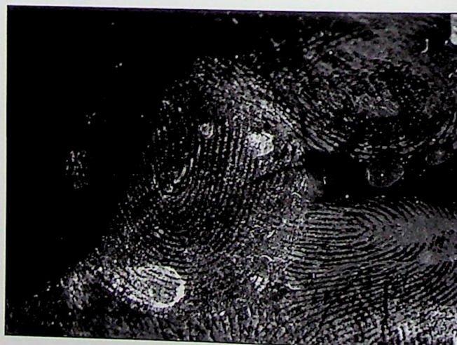
Ryc. 5. Wizualizacja śladu linii papilarnych, ujawnionego cyjanoakrylanem, kontrastowanego TEC, linia 365 nm, tryb – LO, na szklance
