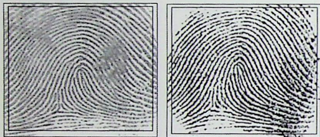
Ryc. 5-6. Odbitki oznaczone jako 9-2-tusz oraz 9-2-skan, brak skrajnych fragmentów na odbitce wykonanej za pomocą LiveSkamera
