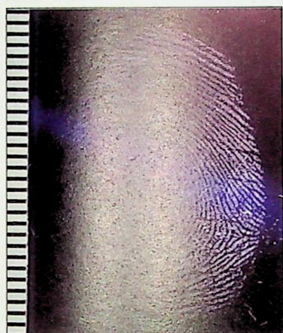
Ryc. 4. Odwzorowanie linii papilarnych ujawnione metodą polimeryzacji cyjanoakrylowej na płycie CD na stronie zapisu danych
