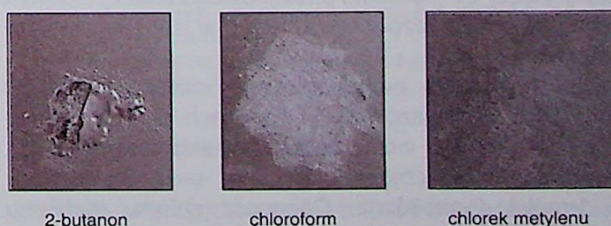
Ryc. 12. Uszkodzenia samochodowej powłoki malarskiej samochodu marki Daewoo wybranymi płynami
