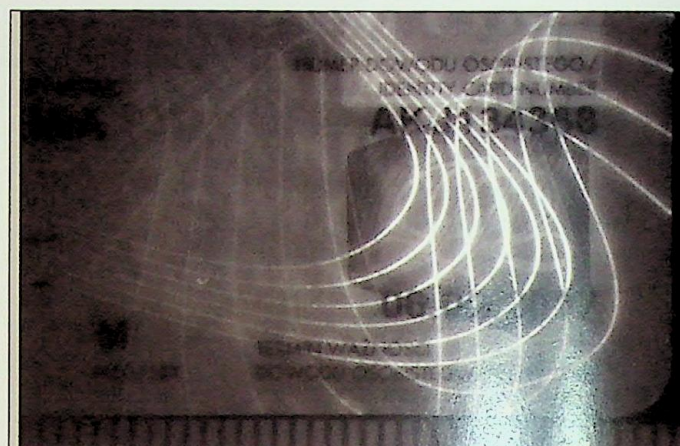
Ryc. 8a. Przykład próby wizualizacji śladu linii papilarnych na dowodzie osobistym przy wykorzystaniu cyjanoakrylanu, chelatu europu oraz oświetlacz UV
