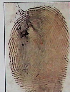
Ryc. 13. Ślad linii papilarnych ujawniony metodą PD na papierze kredowym po jednym dniu moczenia w wodzie
