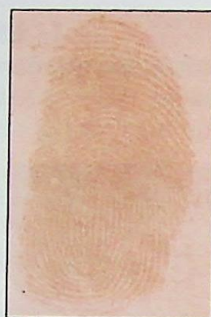
Ryc. 19. Ślad linii papilarnych ujawniony metodą ORO na papierze termoczułym po jednym dniu moczenia w wodzie
