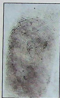
Ryc. 21. Ślad linii papilarnych ujawniony metodą PD na papierze kserograficznym po jednym dniu moczenia w wodzie
