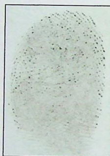
Ryc. 22. Ślad linii papilarnych ujawniony metodą PD na papierze termoczułym po jednym dniu moczenia w wodzie
