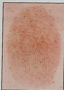
Ryc. 18. Ślad linii papilarnych ujawniony metodą ORO na papierze kserograficznym po jednym dniu moczenia w wodzie
