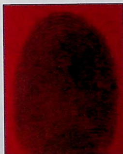
Ryc. 16. Ślad linii papilarnych ujawniony metodą ORO na papierze kredowym po czternastu dniach moczenia w wodzie
