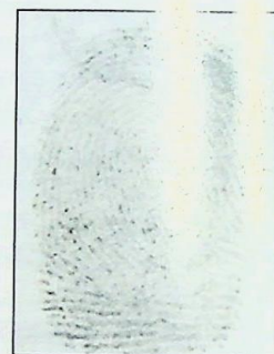
Ryc. 23. Ślad linii papilarnych ujawniony metodą PD na papierze kserograficznym po siedmiu dniach moczenia w wodzie
