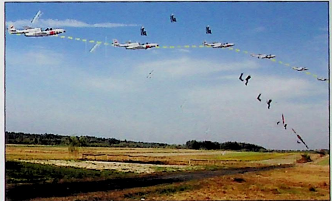
Ryc. 2. Animacja lotu pilota z fotelem po katapultowaniu Fig. 2. Animation of pilot's fall trajectory after catapulting
