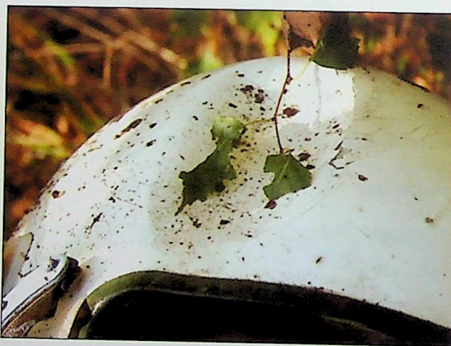
Ryc. 6. Zdjęcie uszkodzenia kasku zrobione na miejscu zdarzenia w niedługim czasie po wypadku Fig. 6. Damage of helmet found at scene shortly after crash
