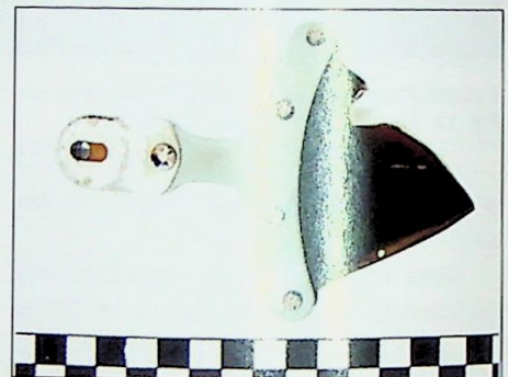
Ryc. 15. Zestawienie jednego z kawałków tworzywa z elementem osłony przy kasku Fig. 15. Fragment of plastic compared with element of helmet screen
