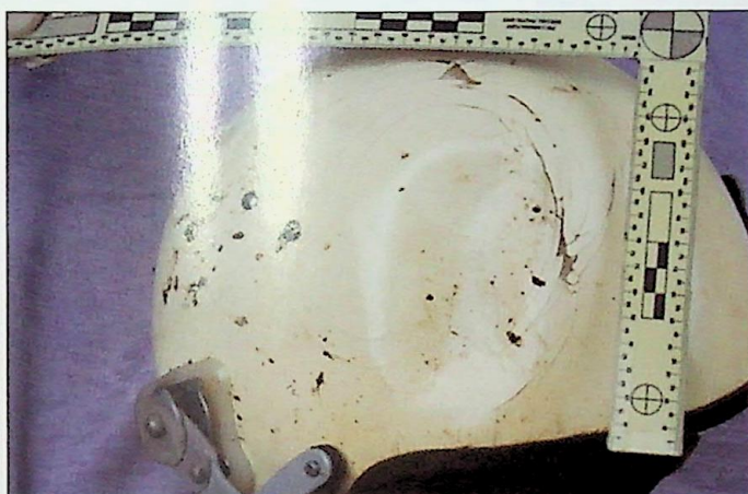
Ryc. 8. Widok uszkodzenia kasku od zewnątrz Fig. 8. Damage on helmet surface
