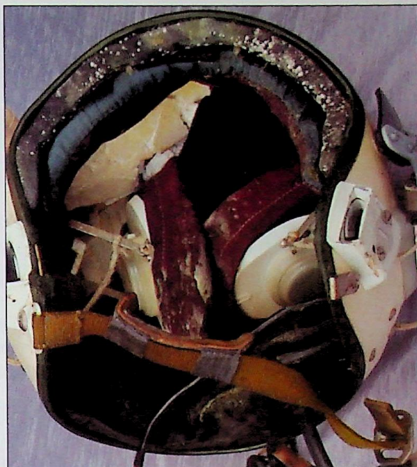
Ryc. 9. Widok uszkodzenia kasku od środka Fig. 9. Inside of damaged helmet
