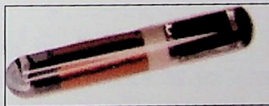
Ryc. 2. Transponder w postaci szklanej kapsułki Fig. 2. Glass capsule transponder
