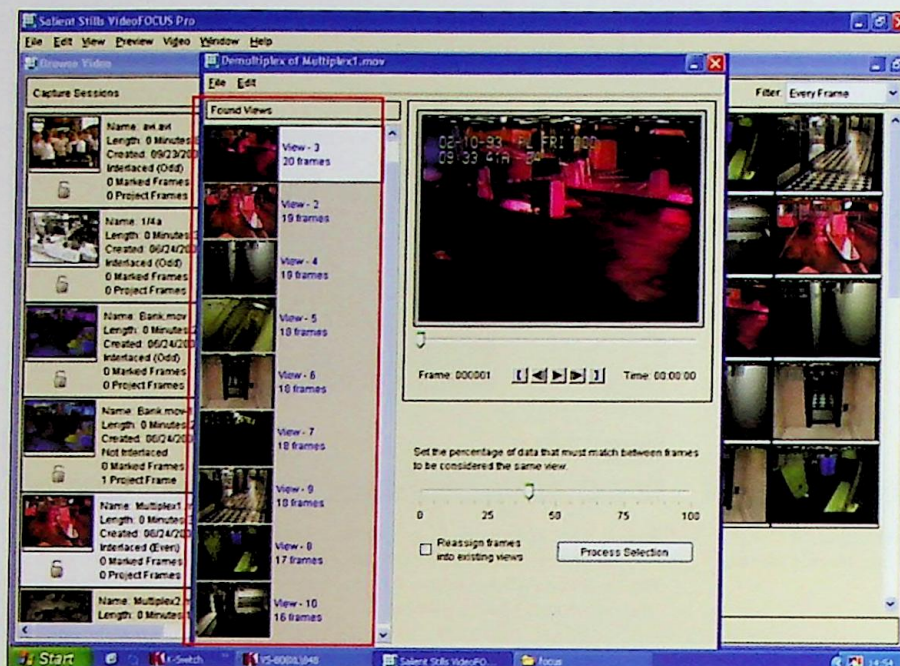
Ryc. 6. Sekwencje wideo (View) odpowiadające obrazom z poszczególnych kamer (9 kanałów oznaczonych jako View 2 do View 10) Fig. 6. Video sequences (View) corresponding to images from individual cameras (9 channels designated as View 2 to View 10)
