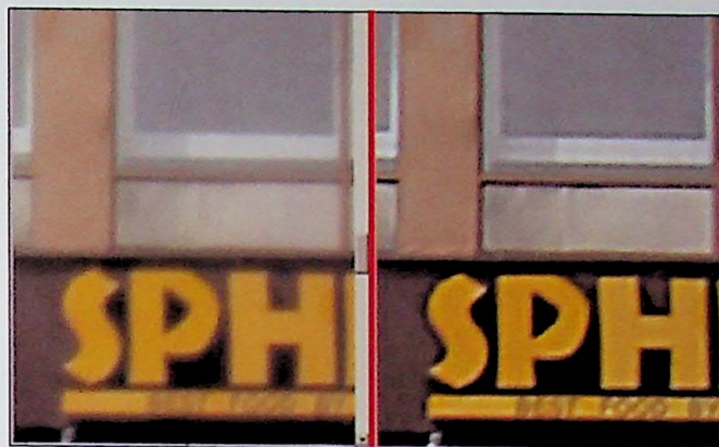
Ryc. 19. 6-krotne powiększenie – widoczne ciemne i jasne obwiednie liter Fig. 19. Six-fold magnification – visible dark and light letter contours
