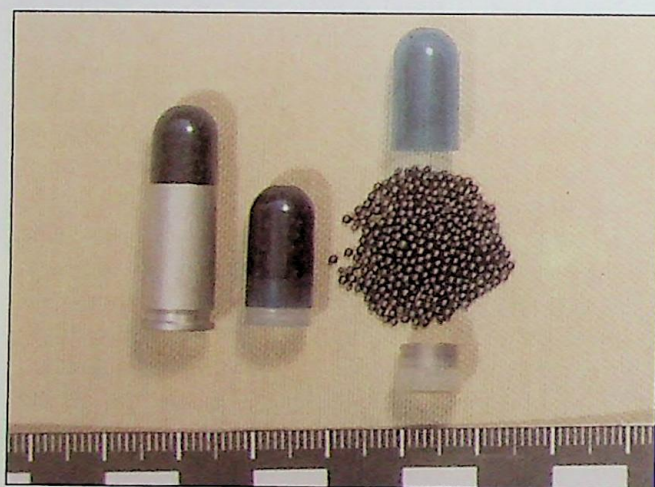
Ryc. 1. Nabój 9 mm Luger CCI „Shotshell”, kontenerowy pocisk śrutowy, komponenty pocisku śrutowego Fig. 1. Cartridge 9 mm Luger CCI „Shotshell”, shot cartridge, components of shot cartridge
