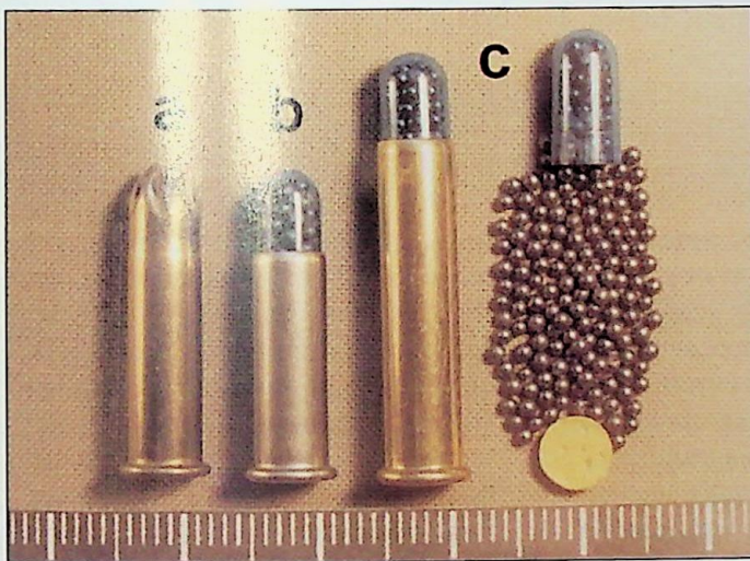
Ryc. 7. Śrutowe naboje bocznego zapłonu. Od lewej: .22 lr CBC/Eley, .22 lr CCI „Shotshell”, .22 WMR CCI „Shotshell”, jego pocisk śrutowy Fig. 7. Rimfire „Shotshell”. Left to right .22 lr-CBC/Eley, .22 lr-CCI, .22 WMR-CCI cartridge and shot pellets
