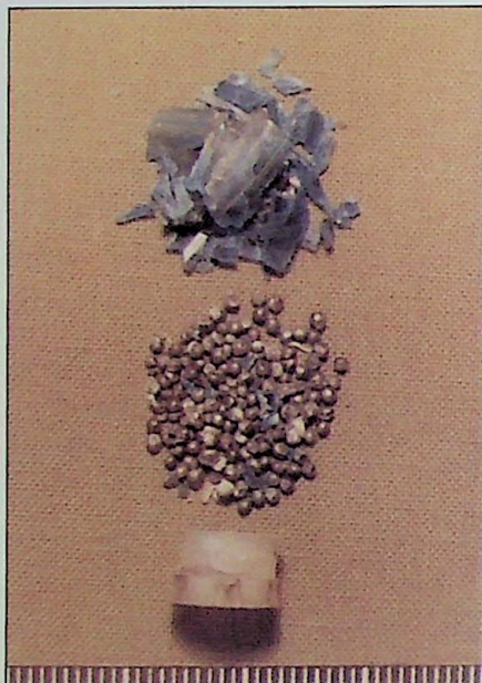
Ryc. 9. Pozostałości powystrzałowe pocisku śrutowego naboju 9 mm Luger CCI „Shotshell” Fig. 9. 9 mm Luger CCI „Shotshell” cartridge residue
