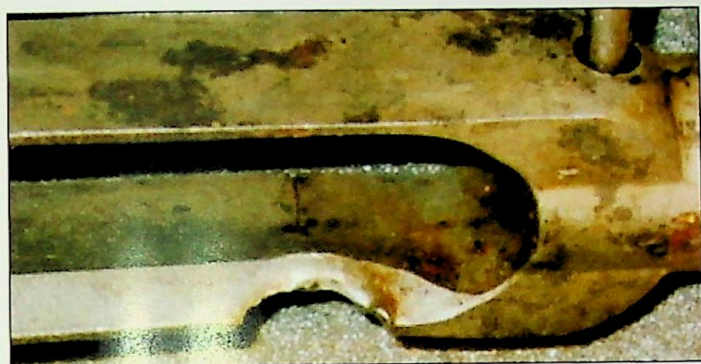
Ryc. 11. Uszkodzenie śruby suwadła – widok z góry, od wewnątrz Fig. 11. Damage of the trigger screw – upper view from the inside
