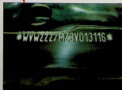
Ryc. 4. Numer identyfikacyjny nadwozia VIN (widoczny po otwarciu pokrywy komory silnika) Fig. 4. VIN identification number of the car body (visible after opening engine chamber cover)
