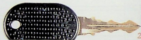
Ryc. 1. Klucz pierwszej generacji o zarysie idealnym Fig. 1. First generation key of ideal
