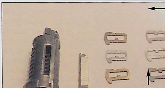
Ryc. 4. Rozmontowana wkładka bębnowa DE Fig. 4. Dismantled DE lock cylinder
