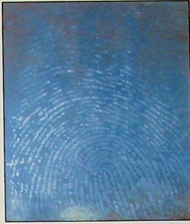
Ryc. 9, 11. Ślady linii papilarnych ujawnione cyjanoakrylanem i kontrastowane Ardroksem (7 – tworzywo sztuczne, 9 – metal, 11 – szkło)
