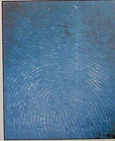
Ryc. 13, 15, 17. Ślady linii papilarnych ujawnione cyjanoakrylanem i kontrastowane Basic Yellow 40 (13 – tworzywo sztuczne, 15 – metal, 17 – szkło)
